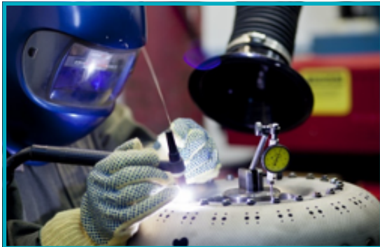
Soudage TIG / procédé de soudage à l'arc
